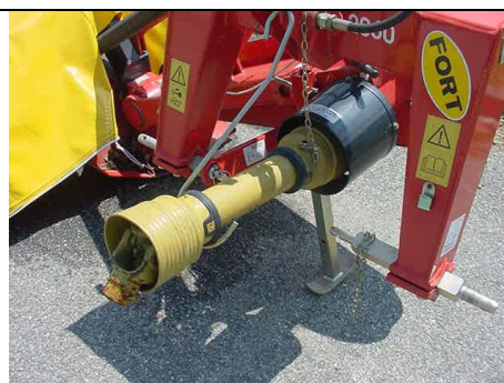
fig. 4 - albero cardanico protetto.
