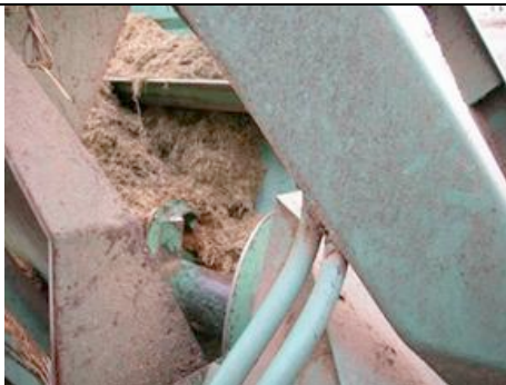
fig. 19 - esempio di coclea accessibile posteriormente non protetta
