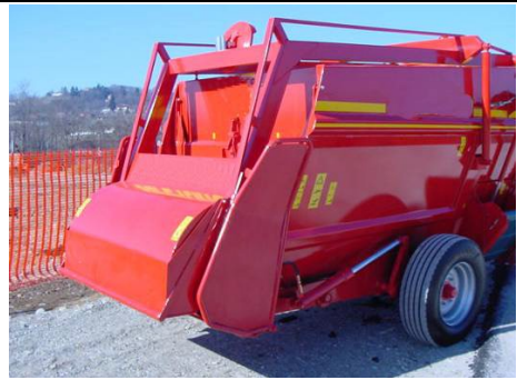
fig. 16 - esempio di protezione frontale della fresa
