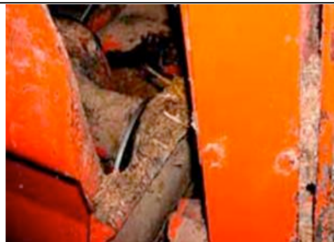
fig. 20 - esempio di coclea accessibile posteriormente non protette
