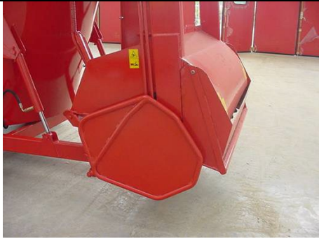
fig. 15 - esempio di dispositivo di protezione laterale
