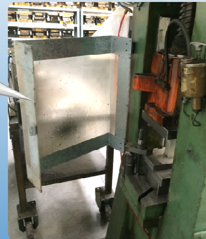
Riparo mobile privo di dispositivo di interblocco
