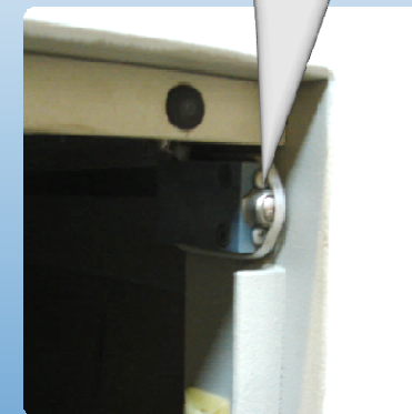
Dispositivo di interblocco eluso
